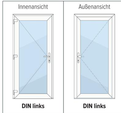
**ACHTUNG:** bei nach außen öffnender Tür wird die DIN-Richtung spiegelverkehrt angegeben!
