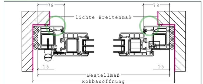
Bei **nach außen öffnenden** Elementen und **Anschlagmauerwerk**
